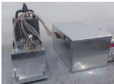
图 9 LPF 惯性传感器前端电子学部件 [13] Fig 9 Inertial sensor front-end electronics component [13]
